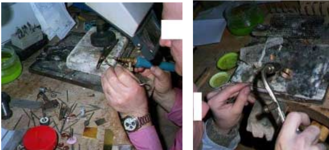
Figure 10 : L'activité mécanique de perçage (à gauche) et de soudure (à droite)
