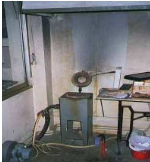
Figure 13 : Poste de la fonte dans l'entreprise A
